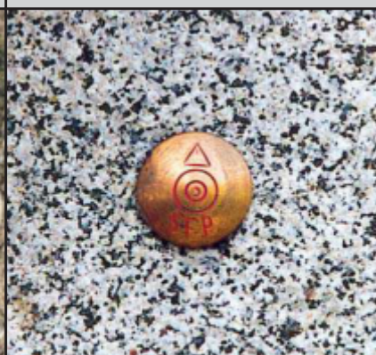
SFP Messingbolzen Ø 3 cm
